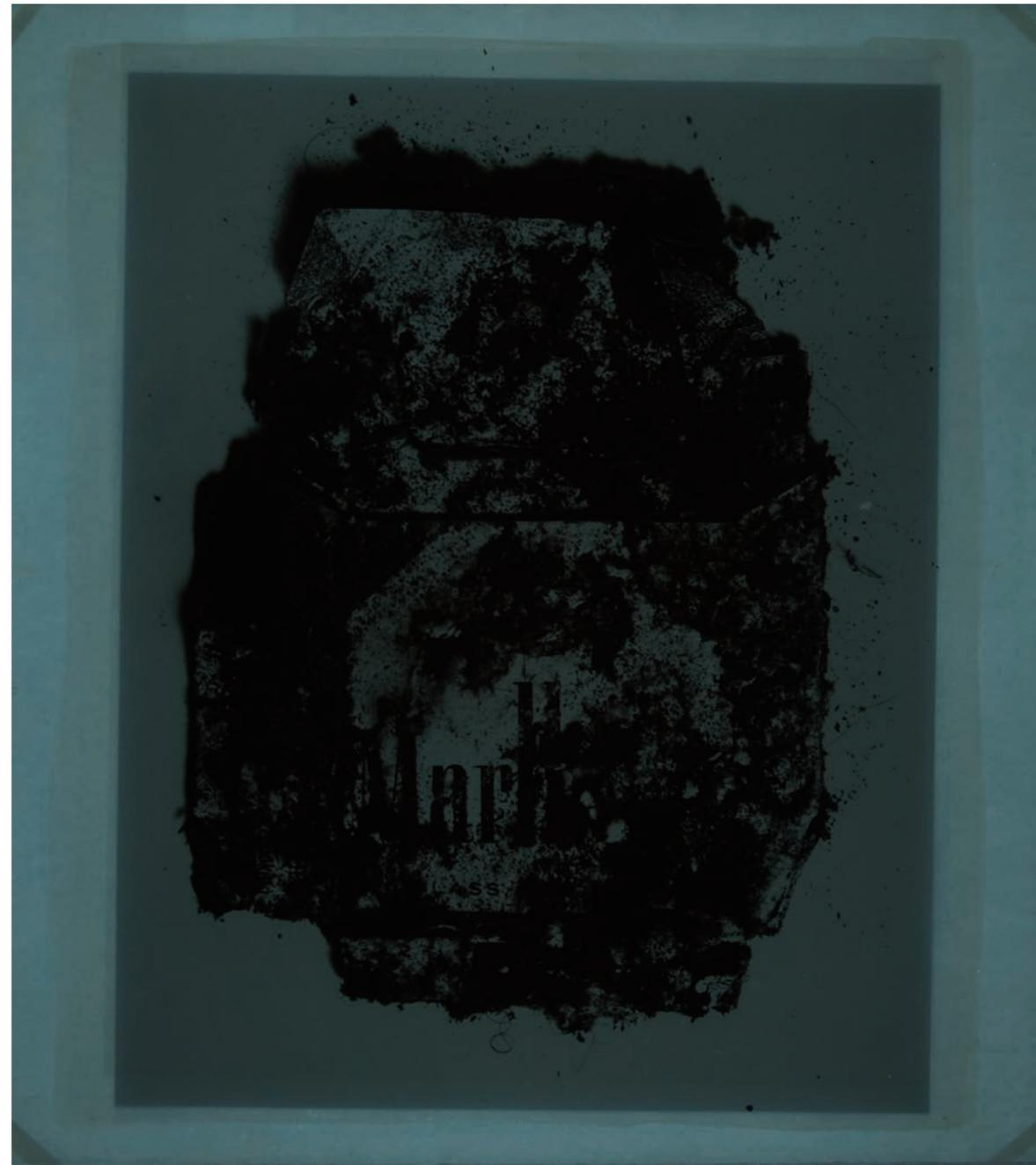
圖4 在長波紫外光燈照射下，黃化的地方沒有螢光反應，但驚奇的發現照片裡沒影像的地方，顯現灰階，因為吸收紫外光。灰階的周圍，有黃棕色的螢光反應，其形狀看似手工塗痕。
